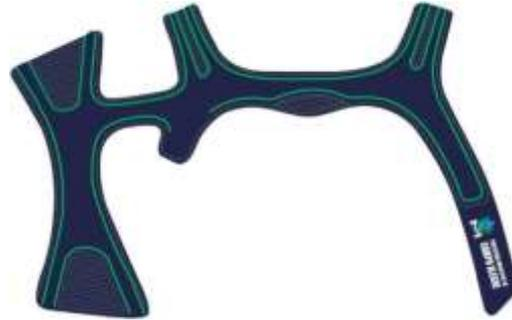
2) PALMILHA AMORTECEDORA - Palmilha de Poliuretano, usando poliuretano poliéter, com alta resistência a hidrólise, na cor Verde semelhante ao Pantone 16-6340 TPX, tendo espessura mínima de 5 milímetros devendo acompanhar exatamente o perfil da forma e estar numerada em todos os tamanhos de forma permanente exatamente conforme a ilustração abaixo:
