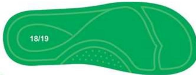
3) SOLA - Peça integrante da base inferior da Papete. Deverá ser fabricado em “PU”, Poliuretano poliéter de alta resistência a hidrolise. Este solado deve ser na cor Azul semelhante ao Pantone 19-3920 TPX, devendo o formato ser com canaletas anti derrapantes. Devendo acompanhar exatamente o perfil da forma. Conforme ilustração abaixo:
